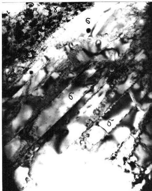
Рисунок 5.8- Сталь 05X22AG15H8M2Ф-Ш, зак.+800°C, охл. с печью, глубина резания 0,15 мм.( частица \sigma -фазы в поверхностном слое).
