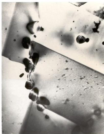
Рисунок 3.17 Структура стали 05X22AG15H8M2Ф после прокатки при 1100°C последующей закалки от 1000°C.
