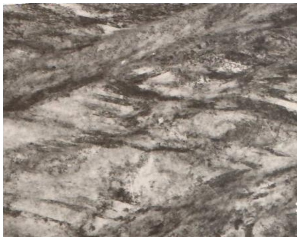
Рисунок 3.27 - Концентрационные области существования \alpha , \epsilon и \gamma -фаз (а) и структура (б) стареющих ванадийсодержащих сталей после деформации при -196°С: а - Г7 – 22Н7 – 16Ф (1100°С – 650°С – 10 час); б – 40Х12Г14Н10Ф (1100°С – 650°С – 10 час), х 38000
