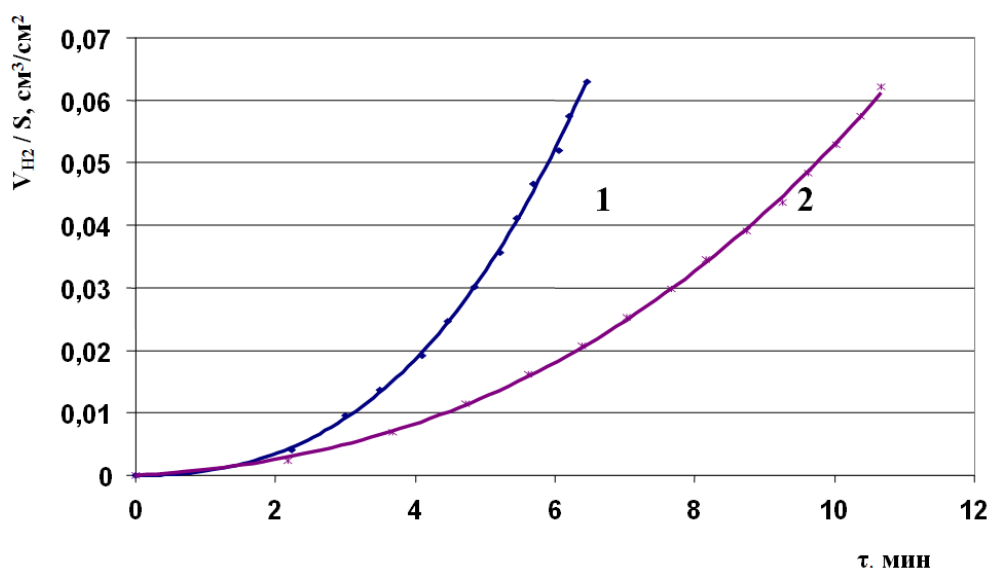
Рисунок 4.36 - Зависимость объёма выделившегося водорода на единицу площади от времени для сжатой (1) и растянутой (2) сторон шлифованной пластины из стали 05X22АГ15Н8М2Ф.
